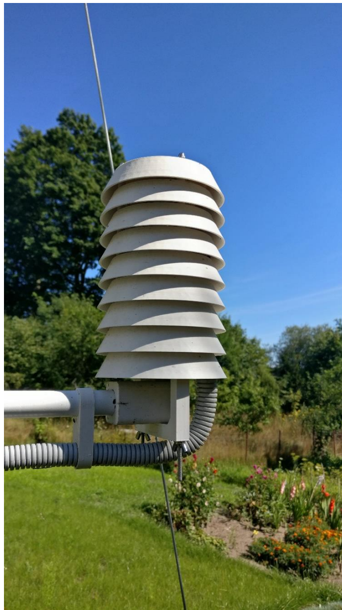
Zdjęcie 3 Osłona radiacyjna czujnika zespolonego (temperatura, wilgotność) Autor: Piotr Wysocki
